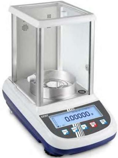
**KERN ALJ 200-5DA** con ionizzatore opzionale **I**, vedere *Accessori*. Bilancia analitica semimicro di alta precisione. L'alta precisione la rende adatta per calibrare le pipette. Suggerimento: Per evitare l'evaporazione, consigliamo i convenienti tubicini capillati (cfr. norma 8655)
