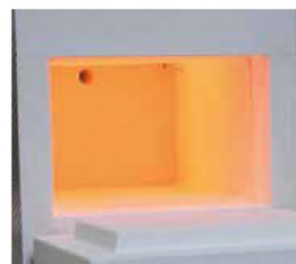
Riscaldamento della muffola da 4 lati
