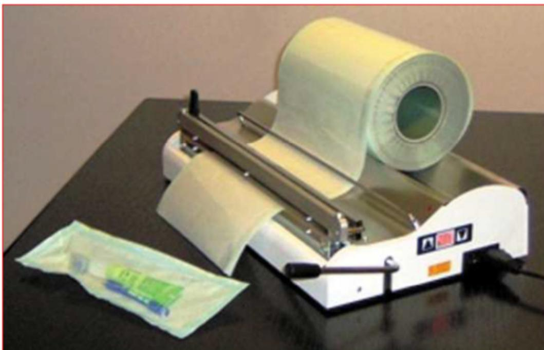
La saldatrice manuale DNT può essere utilizzata per fare sacchetti partendo da bobine di materiale tubolare per sterilizzazione, con o senza soffietti laterali, con larghezza massima cm 25 secondo il modello (qualsiasi lunghezza) e per chiudere i sacchetti dopo che sono stati riempiti.
