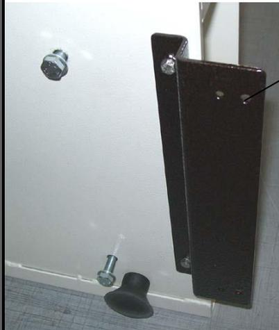
Fori su staffe per il fissaggio dell'agitatore alla superficie di appoggio del tavolo
